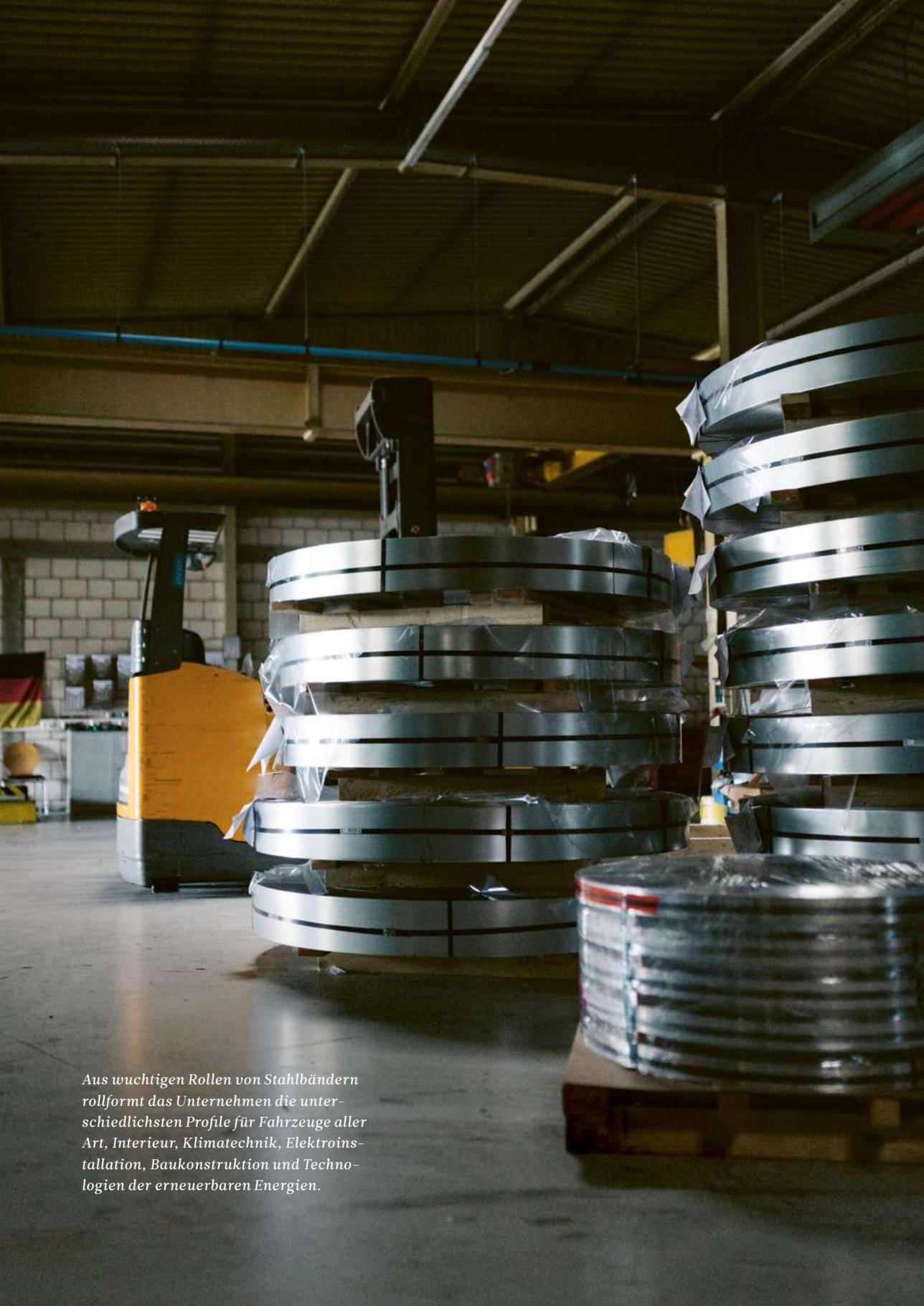
*Aus wichtigen Rollen von Stahlbändern rollformt das Unternehmen die unterschiedlichsten Profile für Fahrzeuge aller Art, Interieur, Klimatechnik, Elektroinstallation, Baukonstruktion und Technologien der erneuerbaren Energien.*
